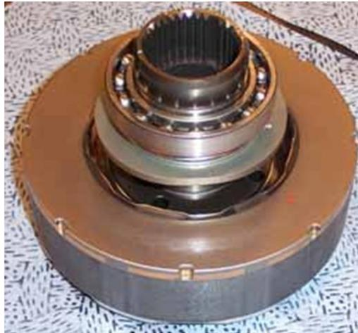
**Fig. 2.7. 2004 Prius generator rotor.**
